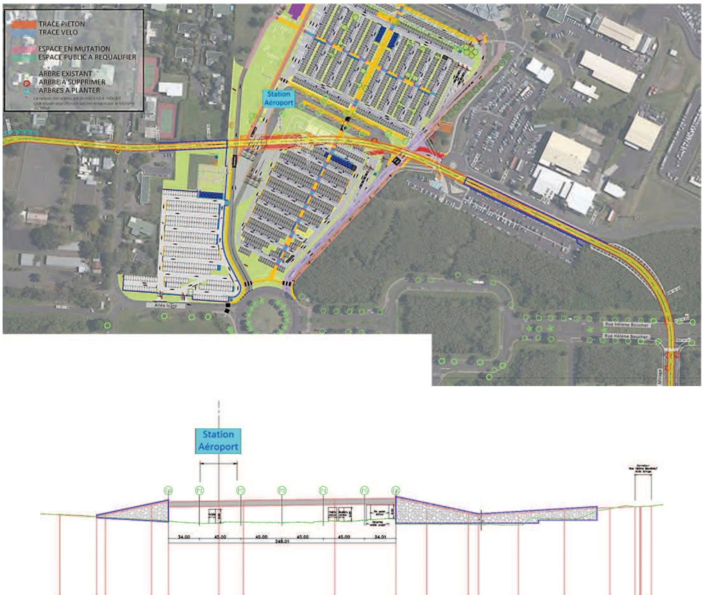
Fig. 26. Principes d'insertion de la traversée de la zone aéroportuaire
