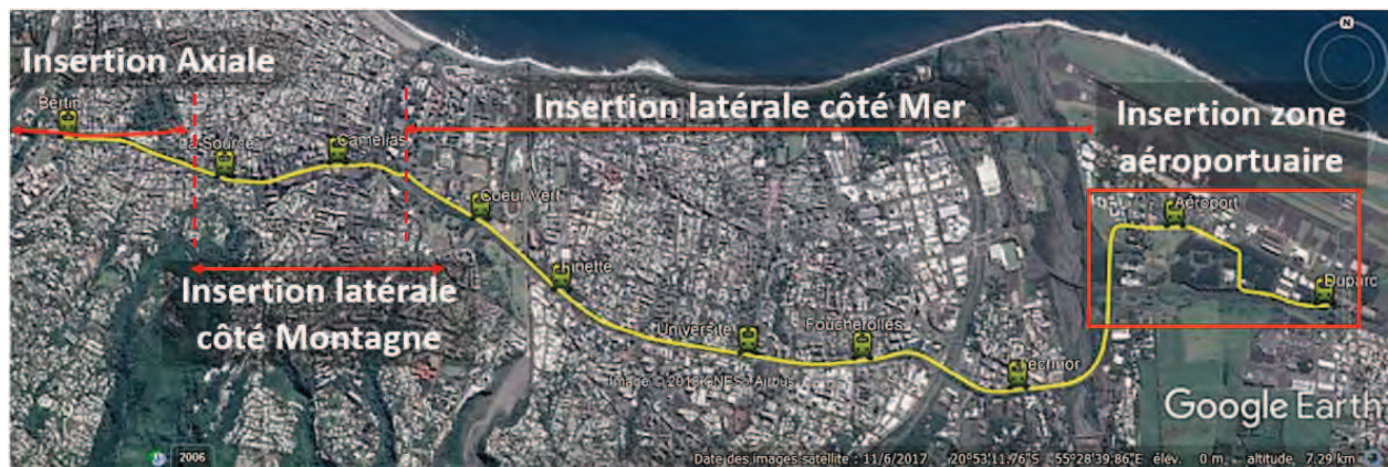
Fig. 15. Principes d'insertion retenus pour le RunRail
