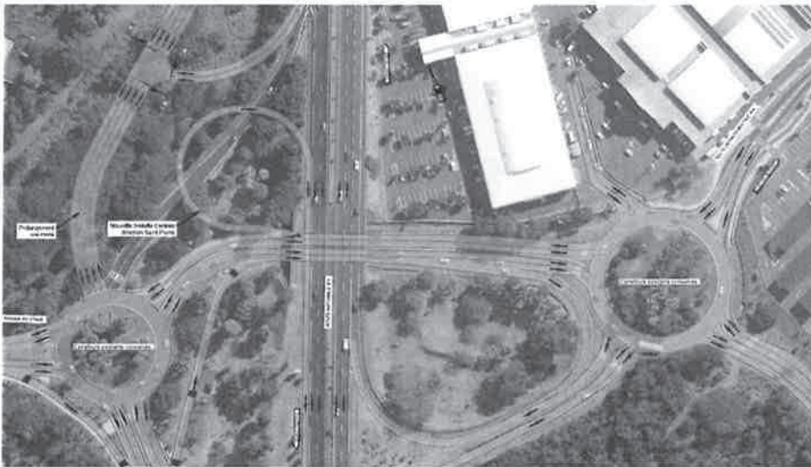
Fig.9 Exemple de reconfiguration de l'échangeur de Savanna avec création d'une sortie dans le sens Nord-Sud au droit de la rue Guldive
