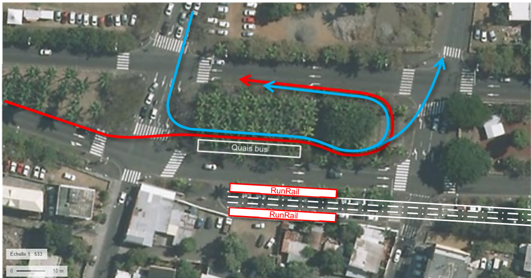
Fig. 7. Possibilité de terminus provisoire avec quais latéraux
