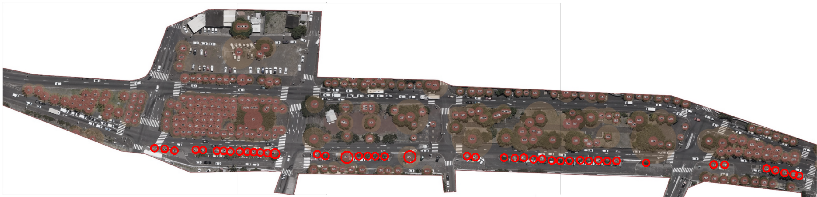
Fig. 5. Variantes B / RunRail latéral Sud : impact potentiel sur les arbres existants
