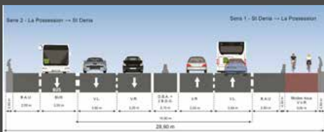
➔ En mode Viaduc avec TCSP et voie vélo
